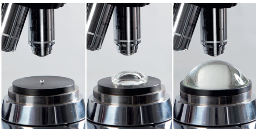
5 Die Flexibilität des PLU apex Systems wird hier durch die Profilmessung an verschiedenen Linsen gezeigt.
